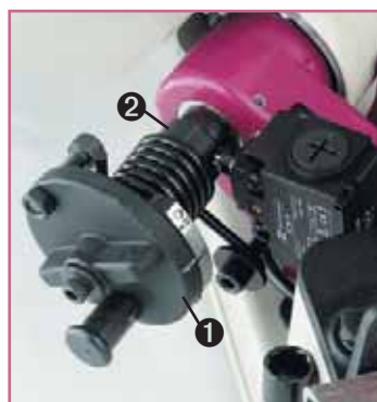
Die Federspannung für den Sägebügelvorschub ist leicht in drei Stufen einstellbar ①. Der Endabschalter wird über einen verstellbaren Nockenring ② justiert
