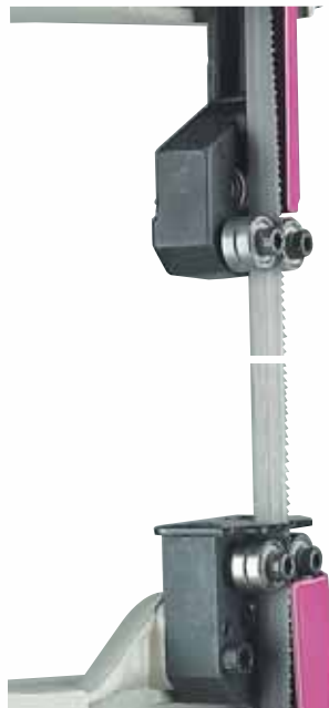
Beide Rollenführungen sind gegenüber den Laufrädern der Bandsäge um 45 Grad gedreht angeordnet, um so das Band senkrecht zu stellen
