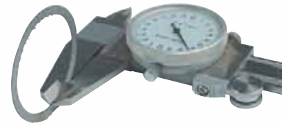
Beweis für sehr ruhigen Lauf: gleichmäßige Scheiben mit einer Dicke weit unter einem Millimeter von einem Stahlrohr mit 3 mm Wandstärke sind kein Problem
