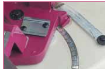
Nach Lösen der Feststellschraube können Gehrungswinkel von 0 bis 45 Grad gewählt werden. Die Anschläge sind über Exzenter justierbar
