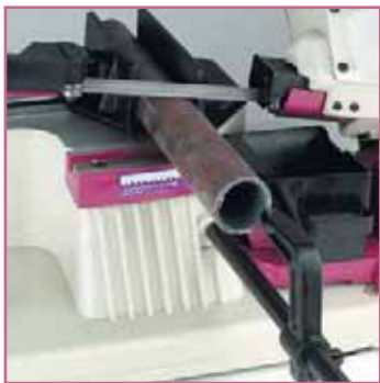
Materialschraubstock mit Schnellverstellung und Feineinstellung mit Kurbelrad. Der Längsanschlag hilft bei Serienschritten
