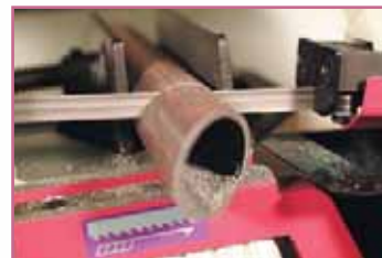
Eine Kunststoffschubblende auf Führungsschienen fängt den Großteil der Sägespäne auf
